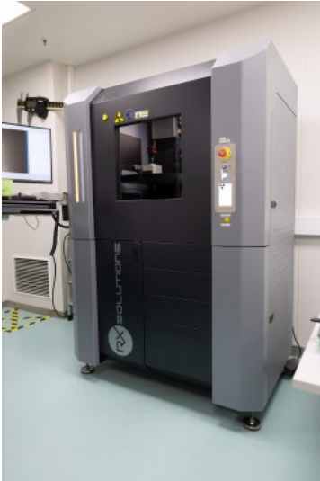
Afbeelding 4: Een recente toevoeging aan de metrologische apparatuur van Nemera is een high-resolution CT)-systeem van RX Solutions, waarmee 3D-beelden van interne componentstructuren en uitgebreide dimensionale analyses kunnen worden gemaakt.
