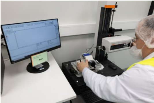
Afbeelding 8: De snelle programmering, opstelling en stylusbeweging van de Mitutoyo Contracer CV2100 maken snelle contourmetingen mogelijk bij Nemera.
