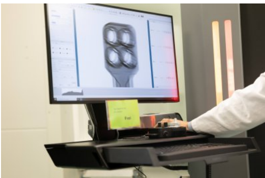
Afbeelding 6: Het CT-systeem genereert nauwkeurige resultaten bij het scannen van de interne structuur van componenten.
